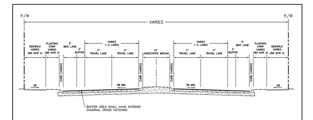
PAVING CURB & GUTTER W/ MEDIAN
