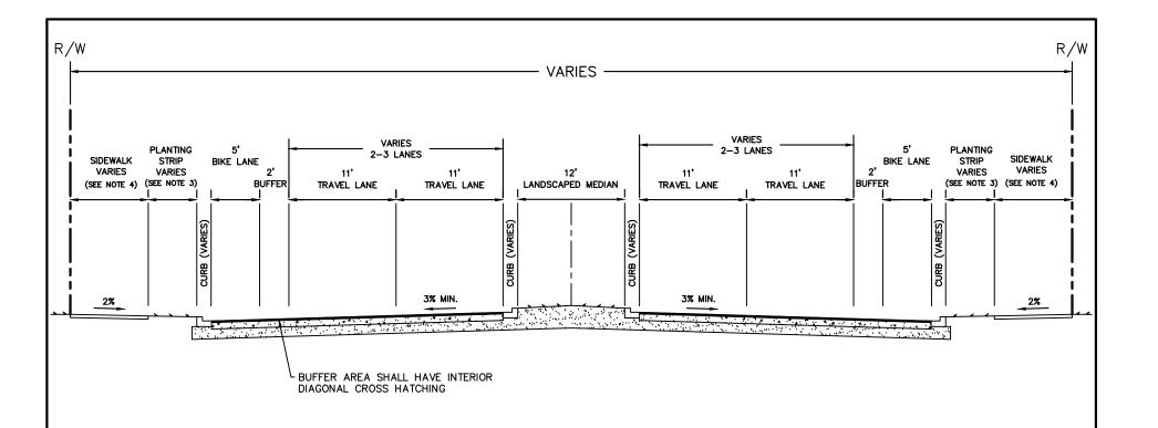
PAVING CURB & GUTTER W/ MEDIAN
