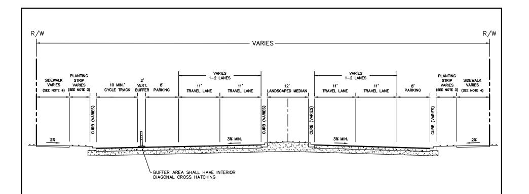
PAVING CURB & GUTTER W/ PARKING
